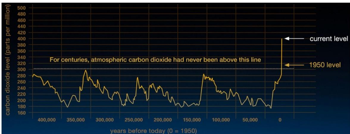
**Figura 3:** Este gráfico, basado en la comparación de muestras atmosféricas contenidas en núcleos de hielo y medidas directas más recientes, provee evidencias de que el CO<sub>2</sub> atmosférico se ha incrementado desde la revolución industrial hasta Febrero de 2016. (Créditos: Vostok ice core data/J.R. Petit et al.;OAA Mauna Loa CO2 record/NASA/JPL, <http://climate.nasa.gov/evidence/>, dominio público).
